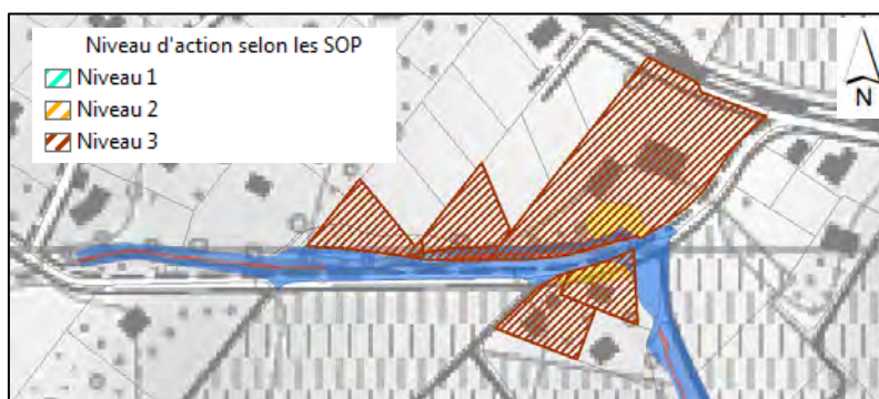
Figure 7 : Niveau d'action pour les zones constructibles des parcelles exposées aux dangers naturels d'inondations sur le territoire du PA de Vuflens-le-Château.
